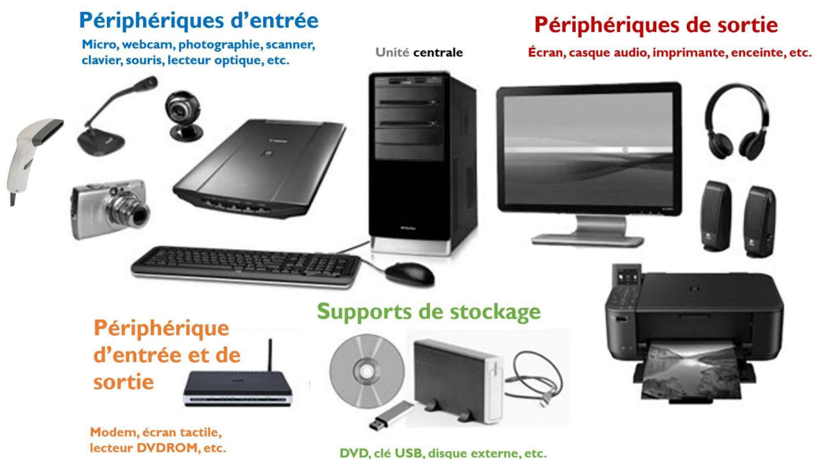
Figure 3 Les périphériques informatiques – Montage S. Python
